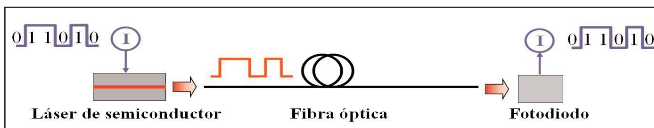
Figura 3. En el caso de un láser de semiconductor, podríamos establecer que para introducir el mensaje codificado correspondiese cada emisión de luz a un uno.
